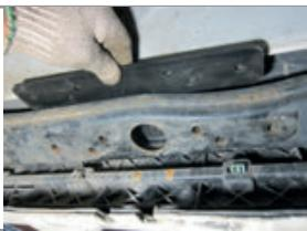
**ШАГ 2.** Для установки фаркопа совместите отверстия в центральном кронштейне с отверстиями задней балки и закладной пластины.
